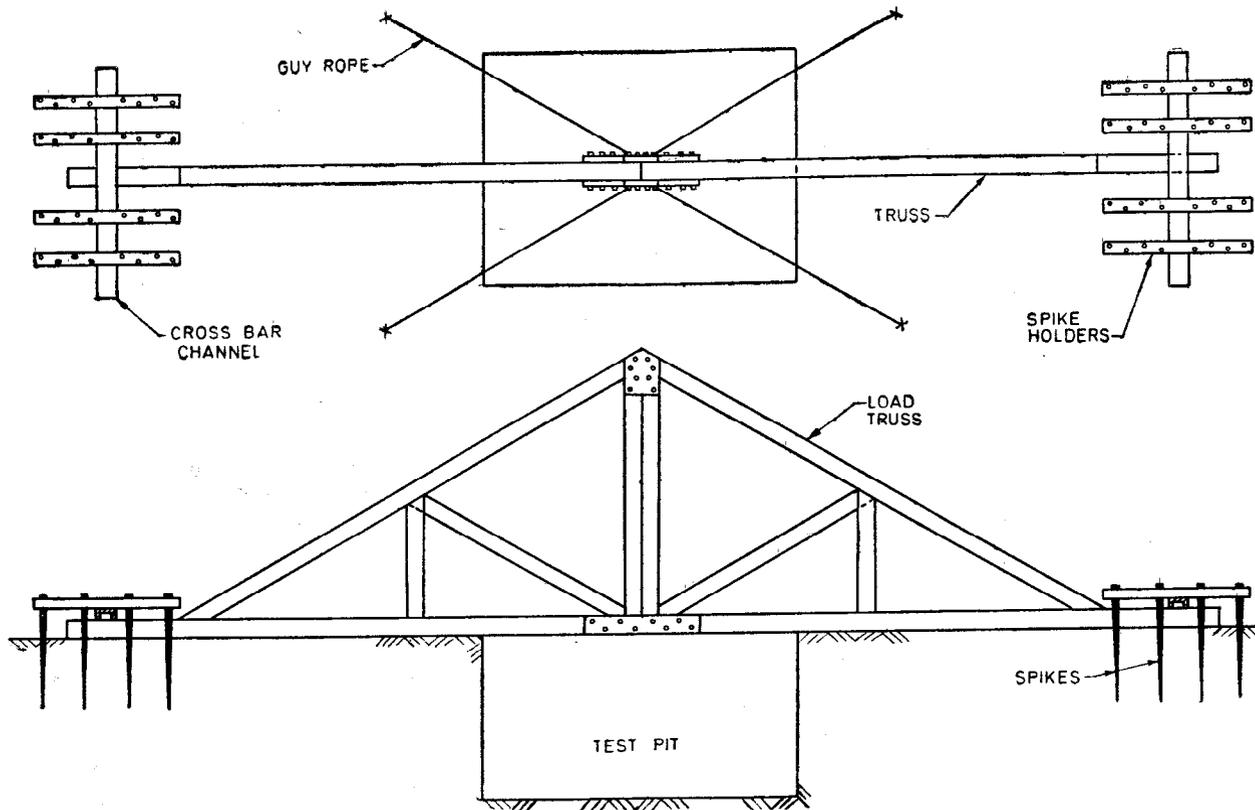
FIG. 3 TYPICAL SET UP FOR LOADING TRUSS
