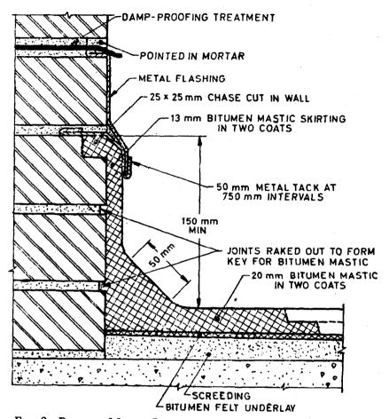
FIG. 2 BITUMEN MASTIC LAID ON SCREEDED ROOF AND BITUMEN MASTIC SKIRTING TO BRICK WALL
