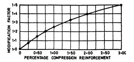
FIG. 5 MODIFICATION FACTOR FOR COMPRESSION REINFORCEMENT
